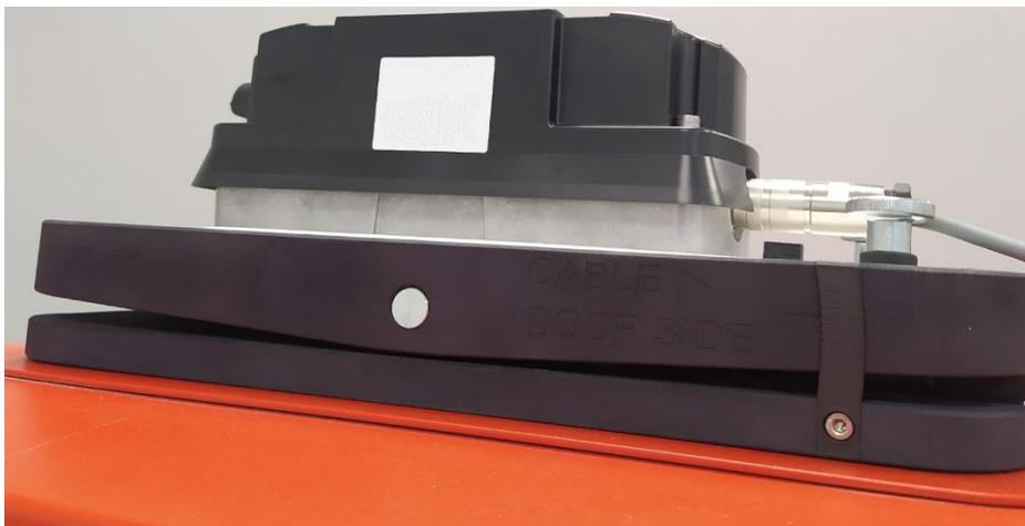
Abbildung 8 Aufsetzen des Simulators und Anschluss des Kabels.
