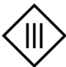
Abbildung 1 Symbol zur Markierung der Schutzklasse III (SELV).
