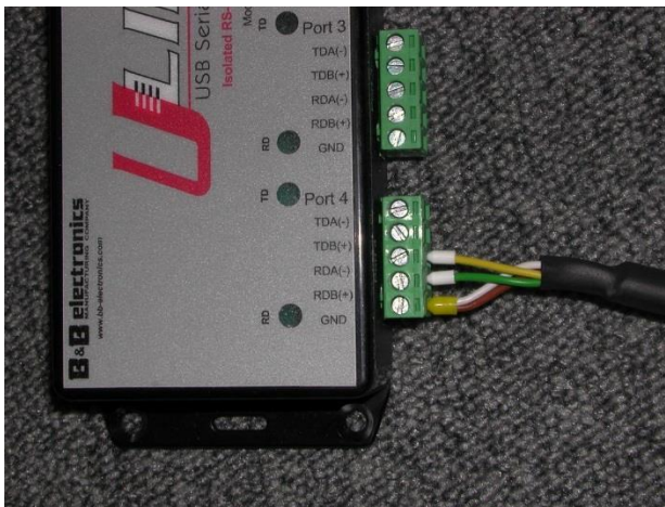
Abbildung 13 RS485 Verbindung zu einem Signalumwandler.
