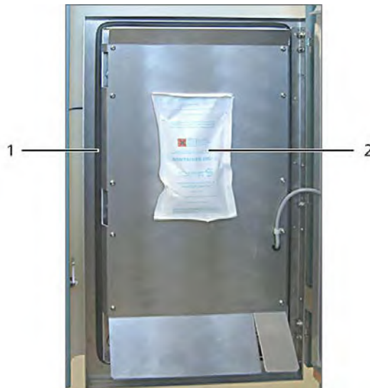
Abbildung 31 Dichtungsgummi (1) und Entfeuchterbeutel (2)
