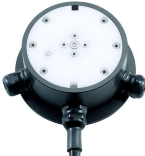
Der aktive Fahrbahn-/Runway-Sensor ARS31 ist bündig in den Belag eingebaut und ermittelt die Gefriertemperatur durch aktives Kühlen und Heizen der Sensoroberfläche.
