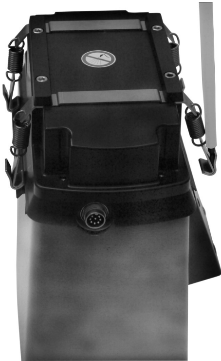
Abbildung 17: Klemmbügel mit Schraubenzieher festklemmen
