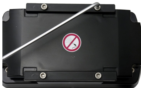
Abbildung 6: Schrauben auf dem MARWIS-Gehäuse lösen
